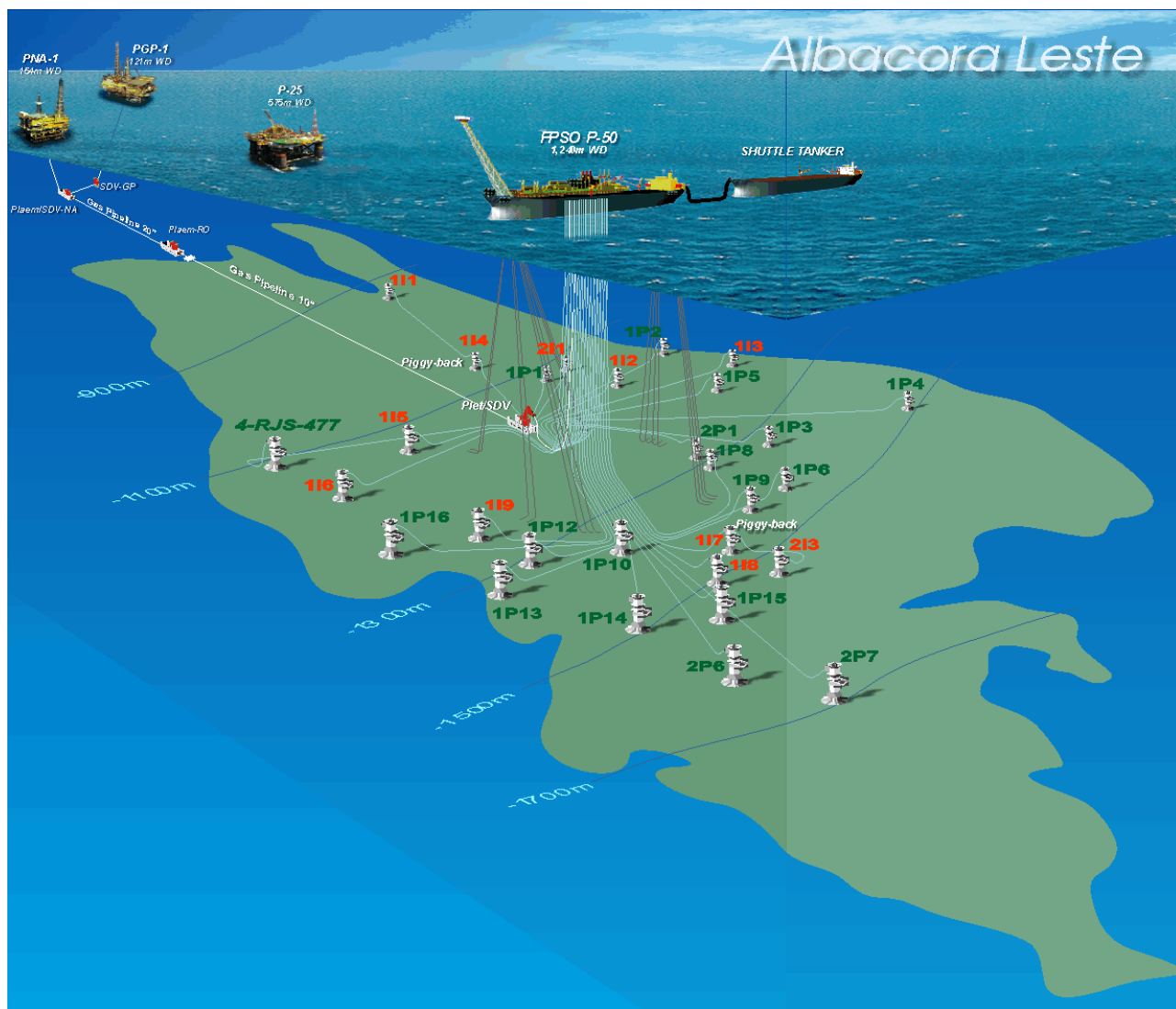
Figura 3.1-b. Ilustração da interligação do sistema submarino ao FPSO P-50 no campo de Albacora Leste
